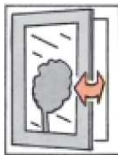
Fig. 8 Bij veel luchtbeweging zowel binnen (tocht, openstaande deur) als buiten (wind) het raam nooit in de draaistand laten staan.
